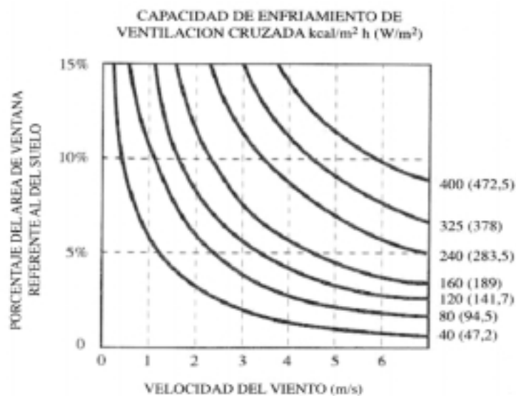
Figura 15. Efecto refrigerante de la ventilación en función de la velocidad del aire y la superficie de abertura (Geohabitat 2002)
